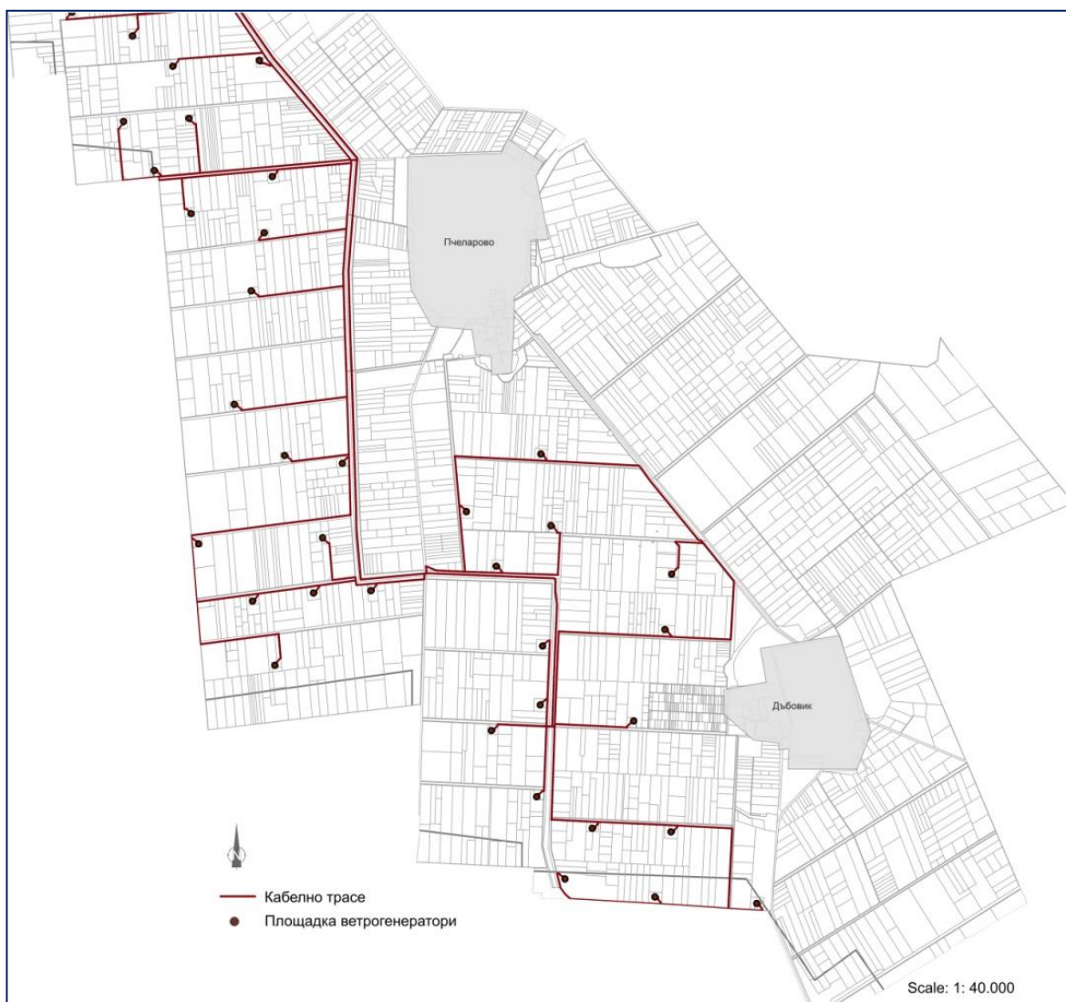
Фиг. 1.5. Схема на кабелно трасе за подобект ВЕП Мизия I
